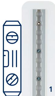
Richte das 1. Wandmodul mit einer Wasserwaage exakt senkrecht an Deiner Wand aus. Dies wird Dein Ausgangspunkt.
