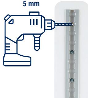
Bohre alle Löcher mit einem Bohrer **ø 5mm** durch das Wandmodul vor.
