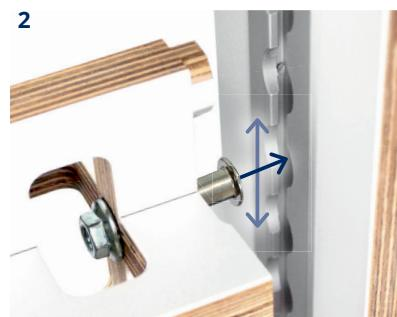
Führe die Schraube in die Schiene ein und positioniere den Knoten.
